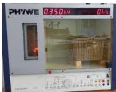
شكل 1. جهاز وحدة الأشعة السينية المستخدم (X-ray Basic Unit, 35kv).
