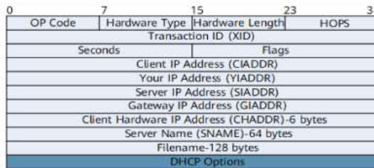
Fig. 4. DHCP Protocol Message Format
